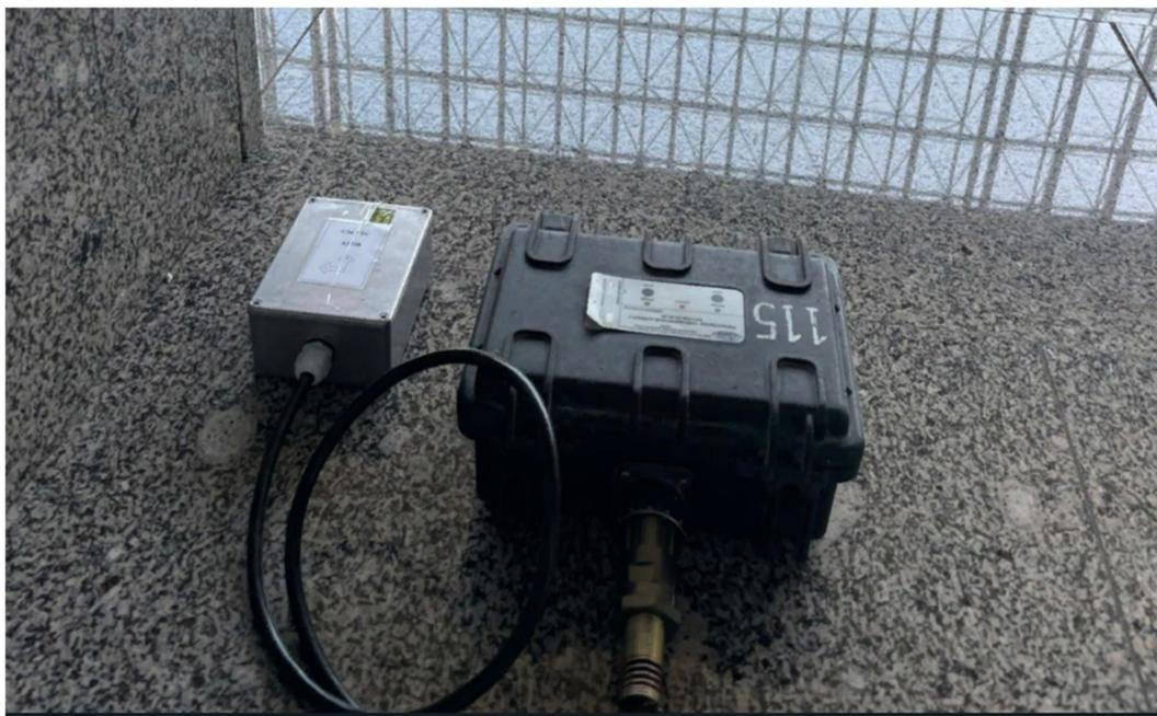
Рисунок 3.54 – Сейсмический регистратор «Байкал-7» с подключенным датчиком-велосиметром GD-4.5
