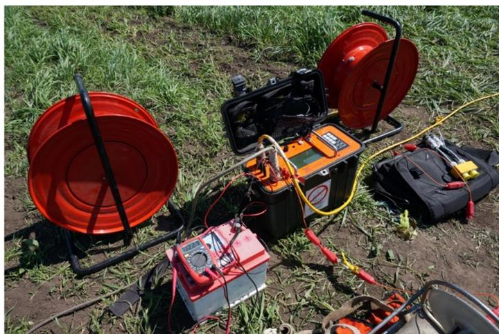
Рисунок 1.20 – Аппаратура «Скала-48», внешний вид и пример полевых работ
