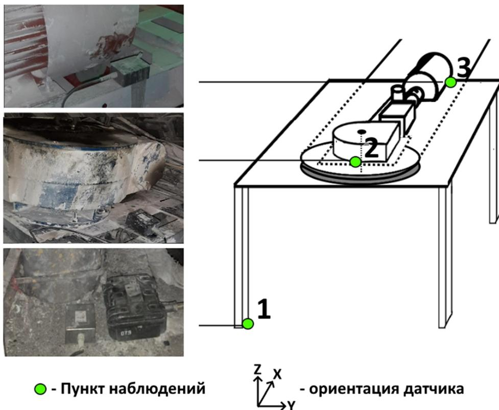
Рисунок 3.70 – Схема сейсмических наблюдений ККД
