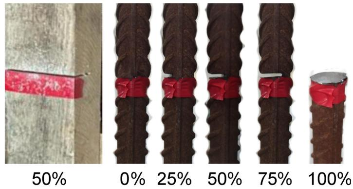
Рисунок 3.82 – Произведенные пропилы в деревянном бруске и арматурном пруте
