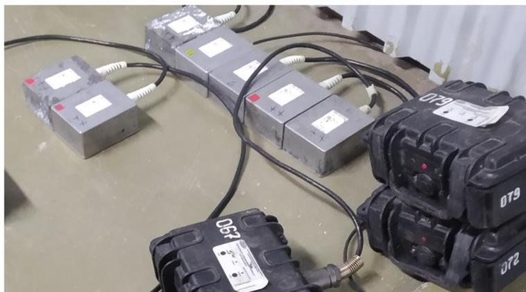
Рисунок 3.2 – Фотографии процесса проведения измерений, пример проведения теста на идентичность комплектов аппаратуры «Байкал-7» и велосиметров GD-4.5
