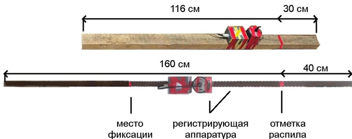
Рисунок 3.81 – Деревянный брусок и арматурный прут с установленной сейсмической аппаратурой
