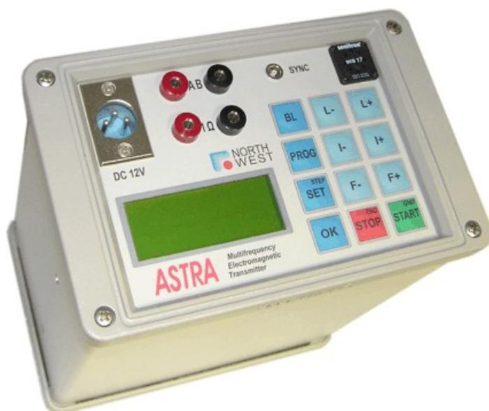
Рисунок 3.114 – Электроразведочный генератор Астра-100
