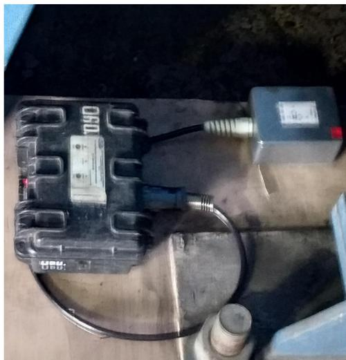
Рисунок 3.71 – Сейсмический регистратор «Байкал-7» с подключенным датчиком-велосиметром GD-4.5
