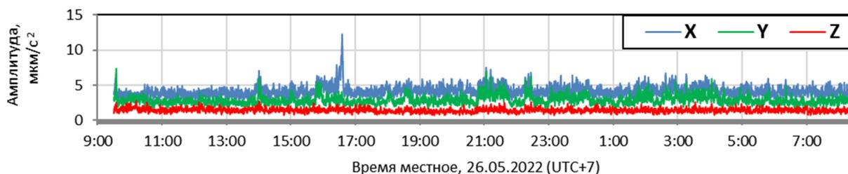
Рисунок 3.62 – График колебаний с частотой 1.36 Гц, полученный с записи с датчика, установленного в верхней части плотины в т.2 у крышки ГА2
