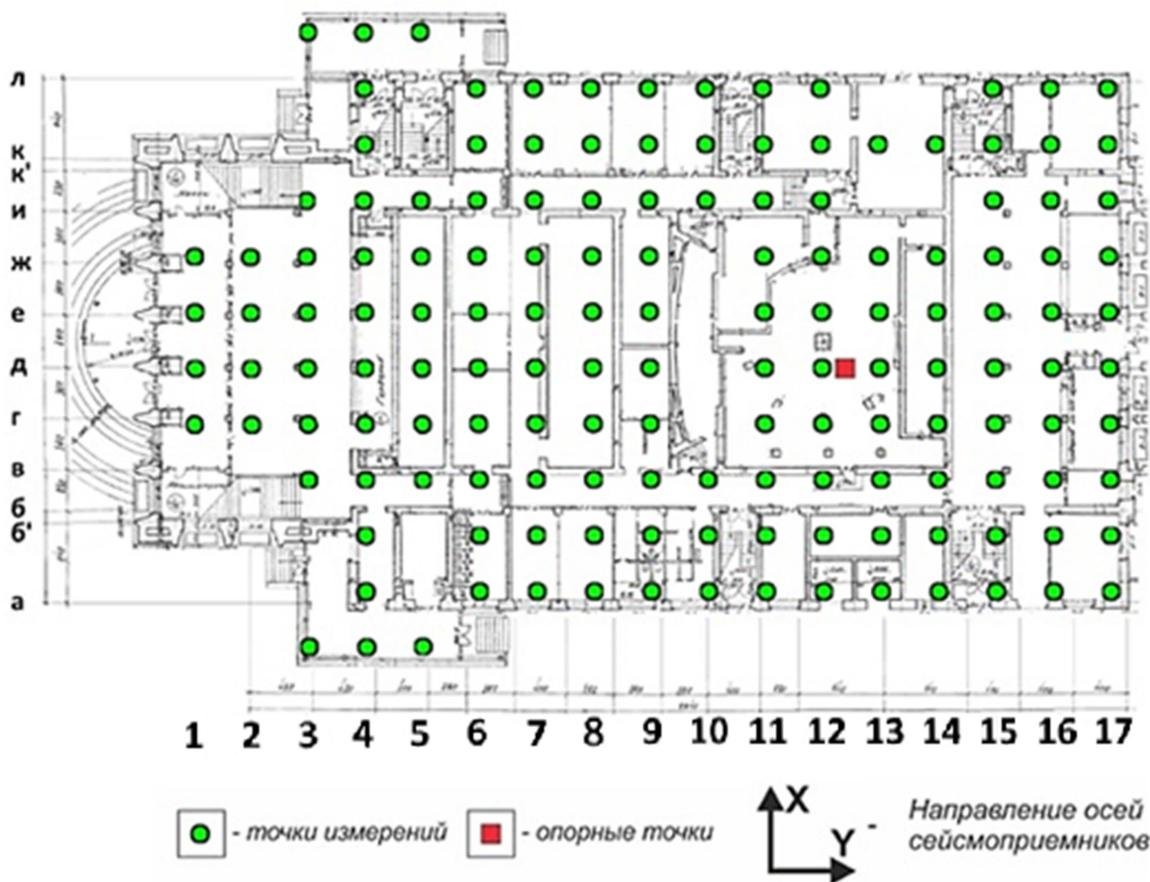
Рисунок 3.20 – Схема наблюдений при регистрации микросейсмических колебаний на первом этаже здания
