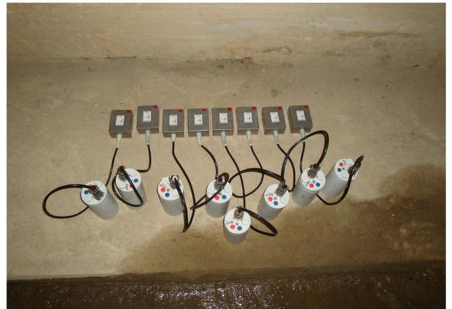
Рисунок 1.7 – Примеры установки регистраторов «Байкал-АСН» с датчиками-велосиметрами GD-10 в плотине Чиркейской ГЭС
