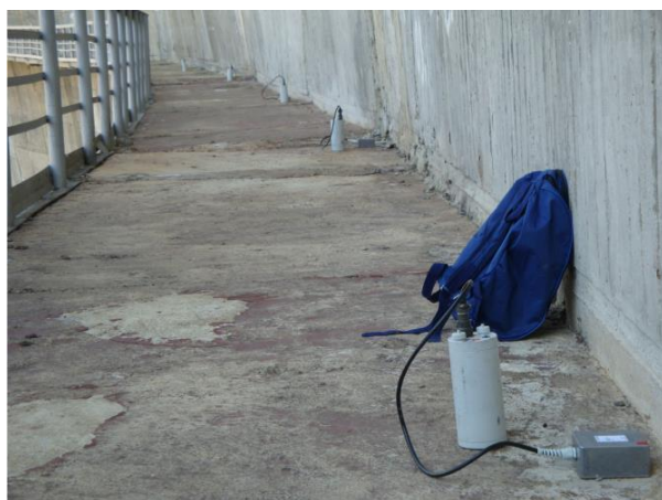
Рисунок 1.7 – Примеры установки регистраторов «Байкал-АСН» с датчиками-велоСИМЕТРАМИ GD-10 в плотине Чиркейской ГЭС
