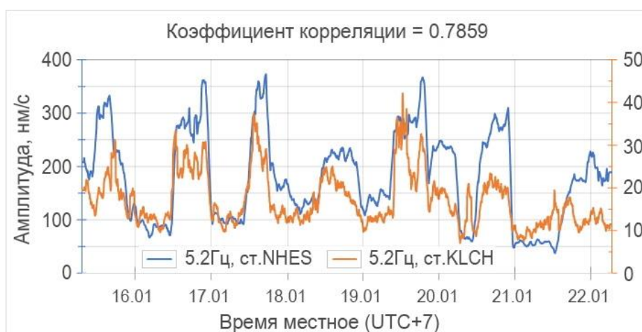
Рисунок 3.34 – Графики изменения амплитуд колебаний на частоте 5.2 Гц, полученные на сейсмостанции НГЭС (синий) и Ключи (оранжевый) с 15 по 22 января 2021 г. Z-компонента
