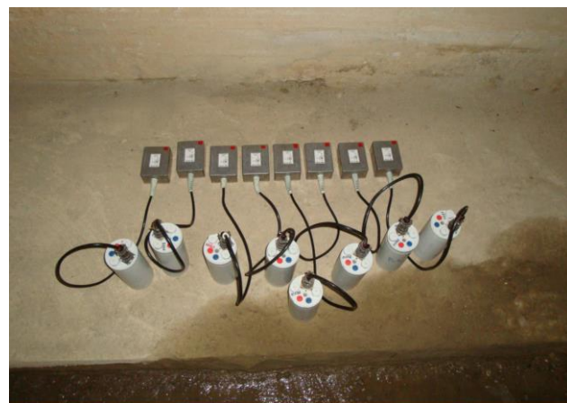
Рисунок 1.7 – Примеры установки регистраторов «Байкал-АСН» с датчиками-велоСИМЕТРАМИ GD-10 в плотине Чиркейской ГЭС
