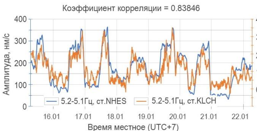
Рисунок 3.35 – График разности амплитуд колебаний исследуемого сигнала на частоте 5.2 Гц с фоном на частоте 5.1 Гц, полученных на сейсмостанции НГЭС (синий) и Ключи (оранжевый) с 15 по 22 января 2021 г. Z-компонента
