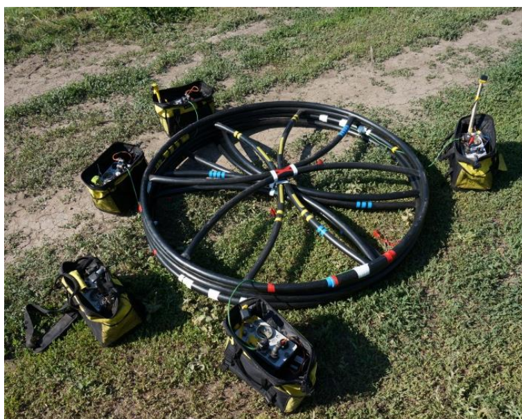
Рисунок 1.19 – Регистратор «Байкал МЭРС-Т» и приемная многовитковая рамка
