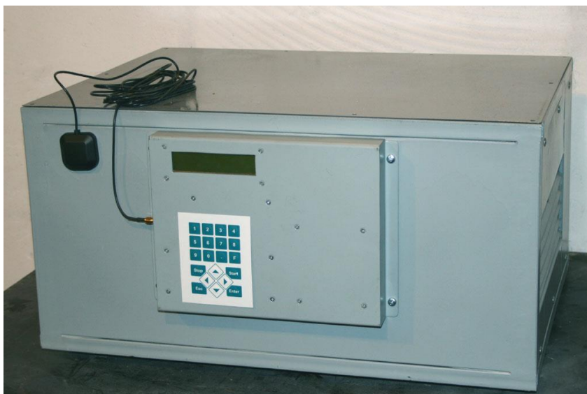
Рисунок 1.16 – Генератор токовых импульсов с амплитудой тока до 200 А
