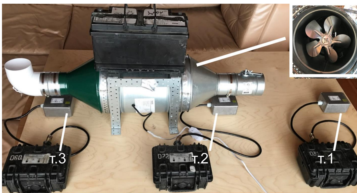
Рисунок 3.62 – Модель вентиляционной установки и схема сейсмической регистрации
