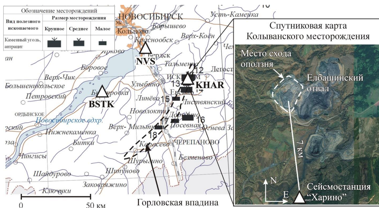
Рисунок 3.38 – Схема сейсмологических наблюдений на карте угольных месторождений Новосибирской области [14]
