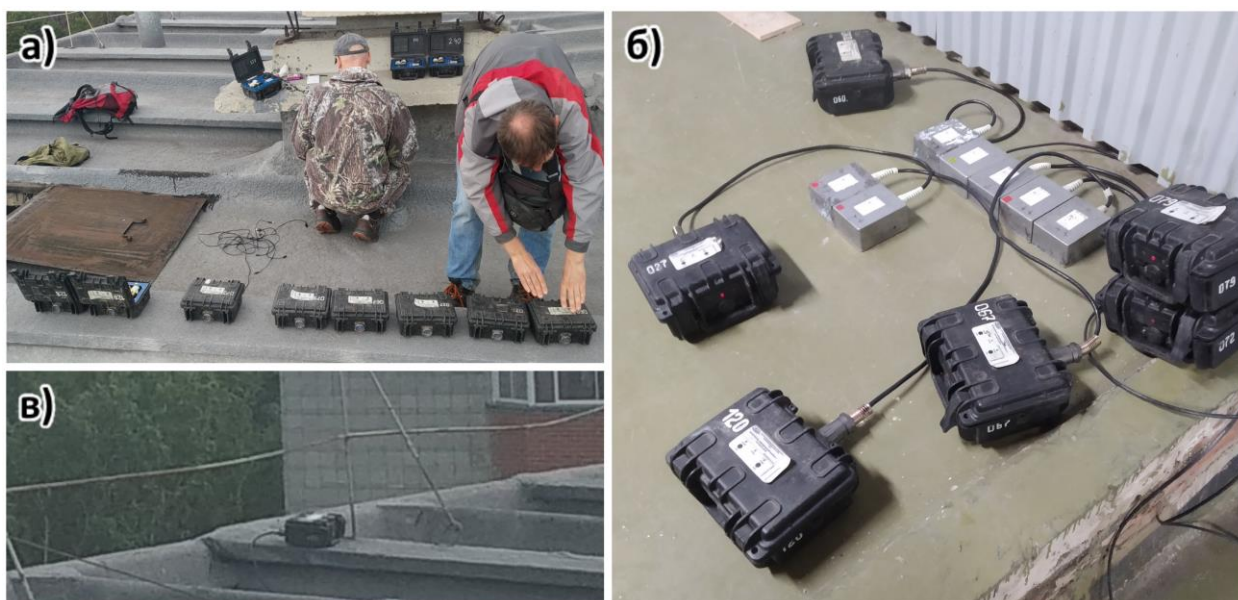
Рисунок 3.15 – Фотографии процесса проведения измерений: (а) – процесс программирования аппаратуры; (б) – пример проведения теста на идентичность; (в) – проведение измерений на крыше здания
