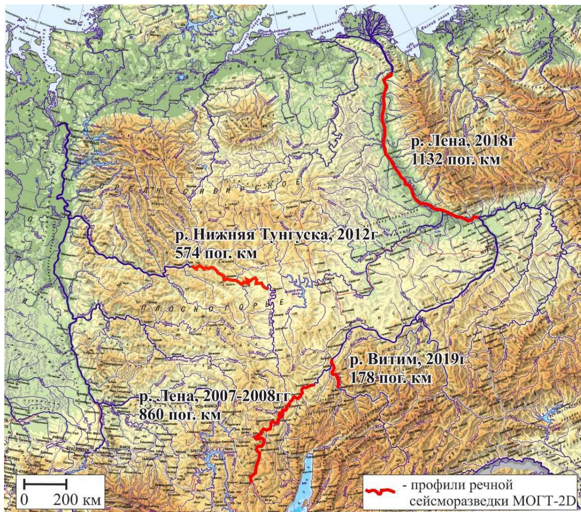
Рисунок 3.71 – Схема профилей речной сейсморазведки МОГТ-2D, по которым имеются архивные данные для переинтерпретации с целью изучения глубинного строения земной коры
