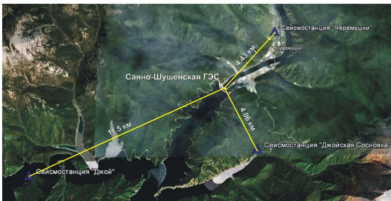
Рисунок 1.3 – Схема сейсмических наблюдений на станциях сейсмологической сети «Черемушки», «Джой» и «Джойская Сосновка»
