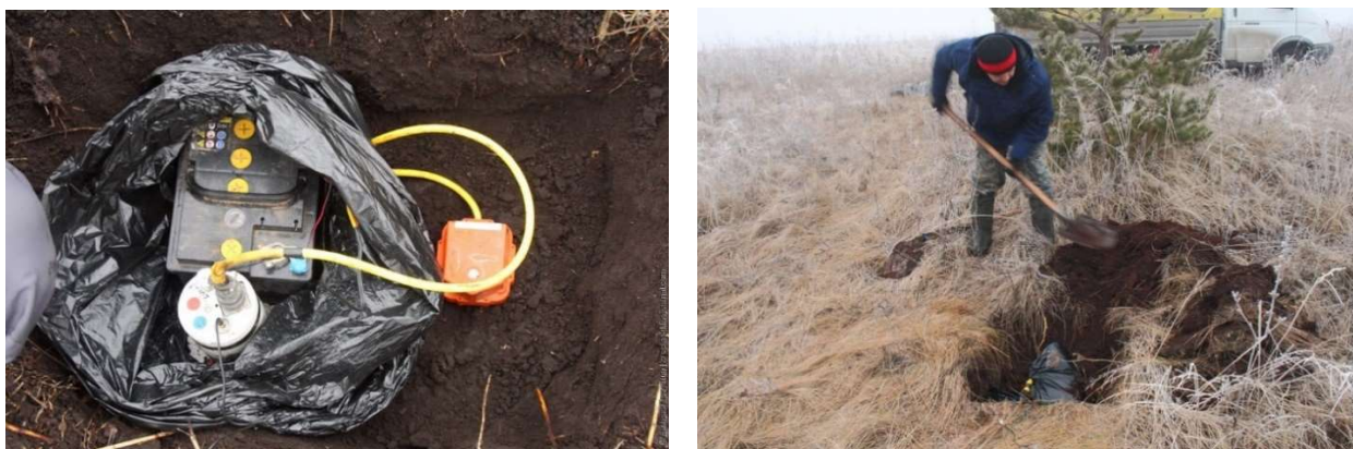
Рисунок 1.12 – Реализованная схема наблюдений (а) и пример установки регистратора «Байкал-АСН» с трехкомпонентным сейсмоприемником GS-One при выполнении сейсмических исследований на Бавлинском месторождении (Респ. Татарстан, 2017 г)
