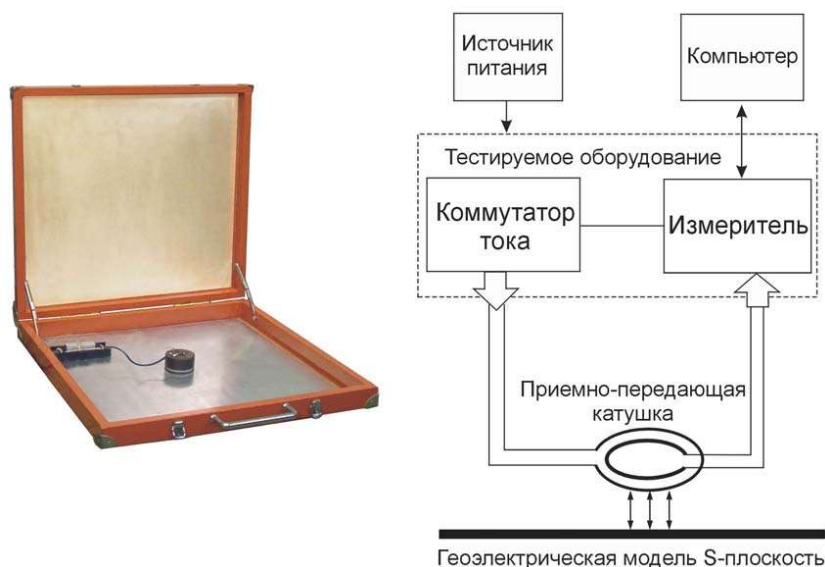
Рисунок 3.124 – Общий вид физической модели и схема системы измерений
