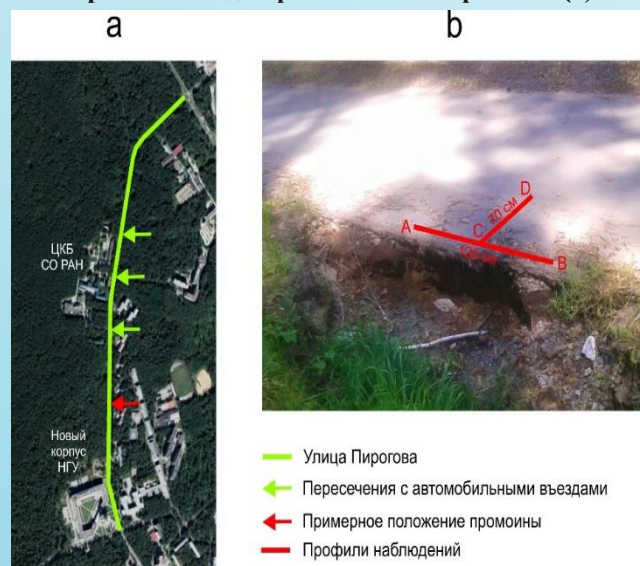
Схема участка проведения работ (а) промоина под асфальтовым покрытием (б)
