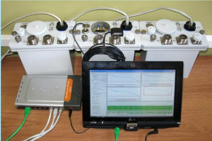
Модули электроразведочной станции «Байкал МЭРС Т»
