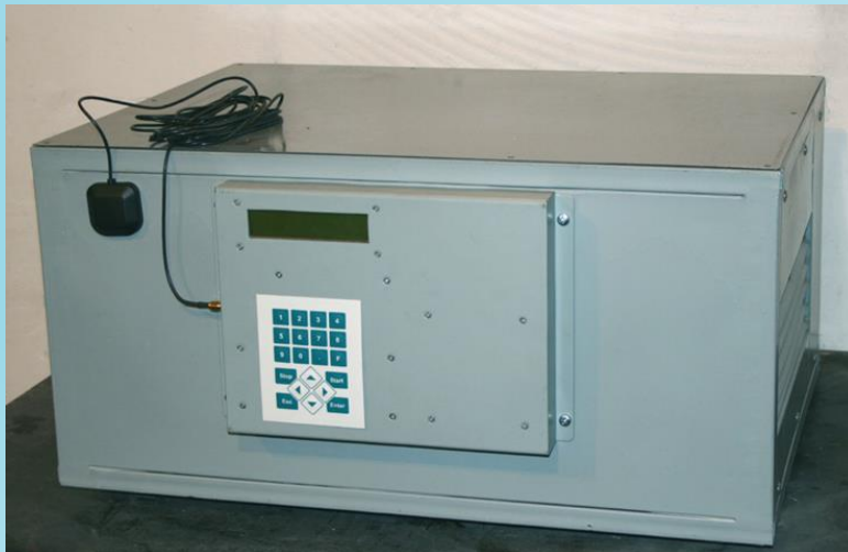
Генератор токовых импульсов с амплитудой тока до 200 А.
